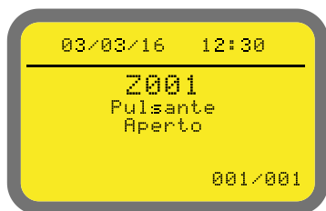
AMARILLO - aviso avería/anomalía
