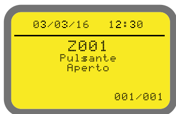
GIALLO - segnalazione guasto/anomalia
